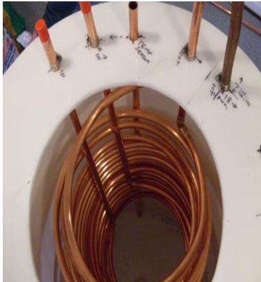
الصورة (10.9): المُبدّل الحراري (Heat Exchanger) (المصدر: انظر فهرس الصور)
